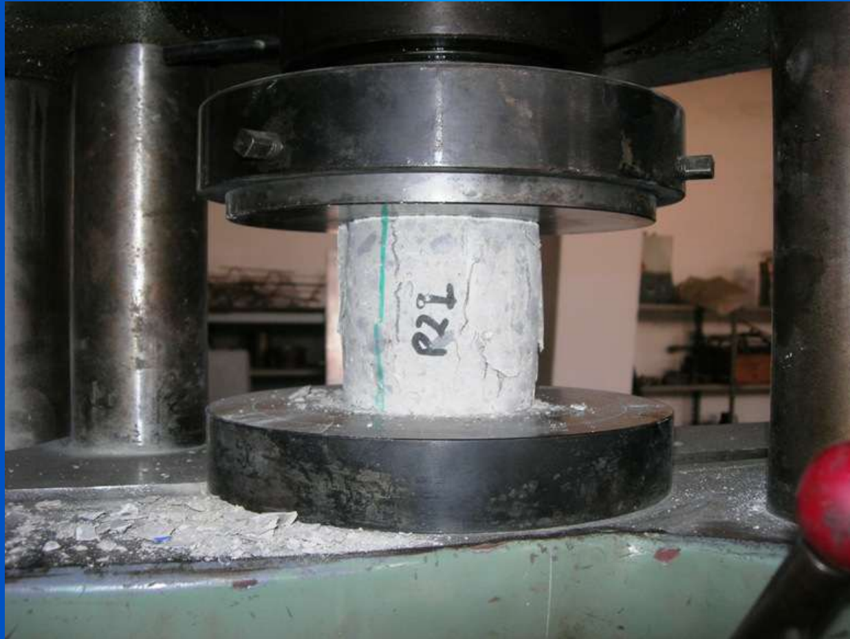
Carota di calcestruzzo sottoposta a prova di compressione
