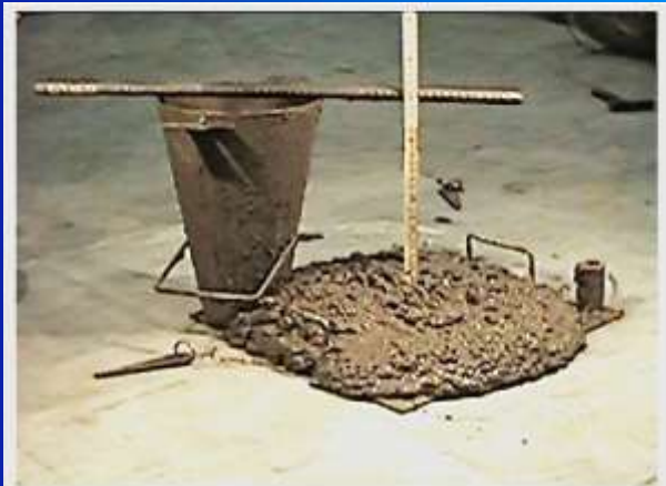
Consistenza S5 slump > 220 mm
