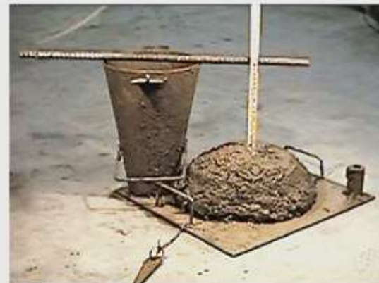
Consistenza S4 slump 160 - 210 mm
