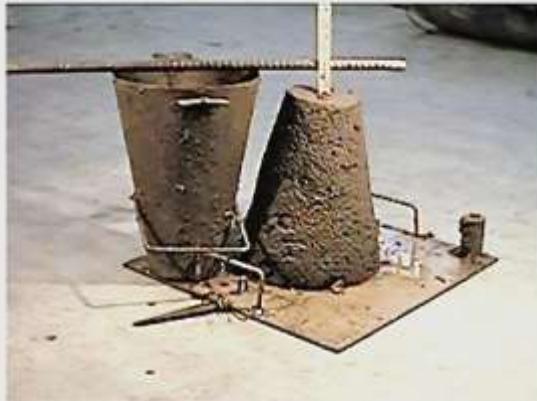
Consistenza S1 slump 10 - 40 mm
