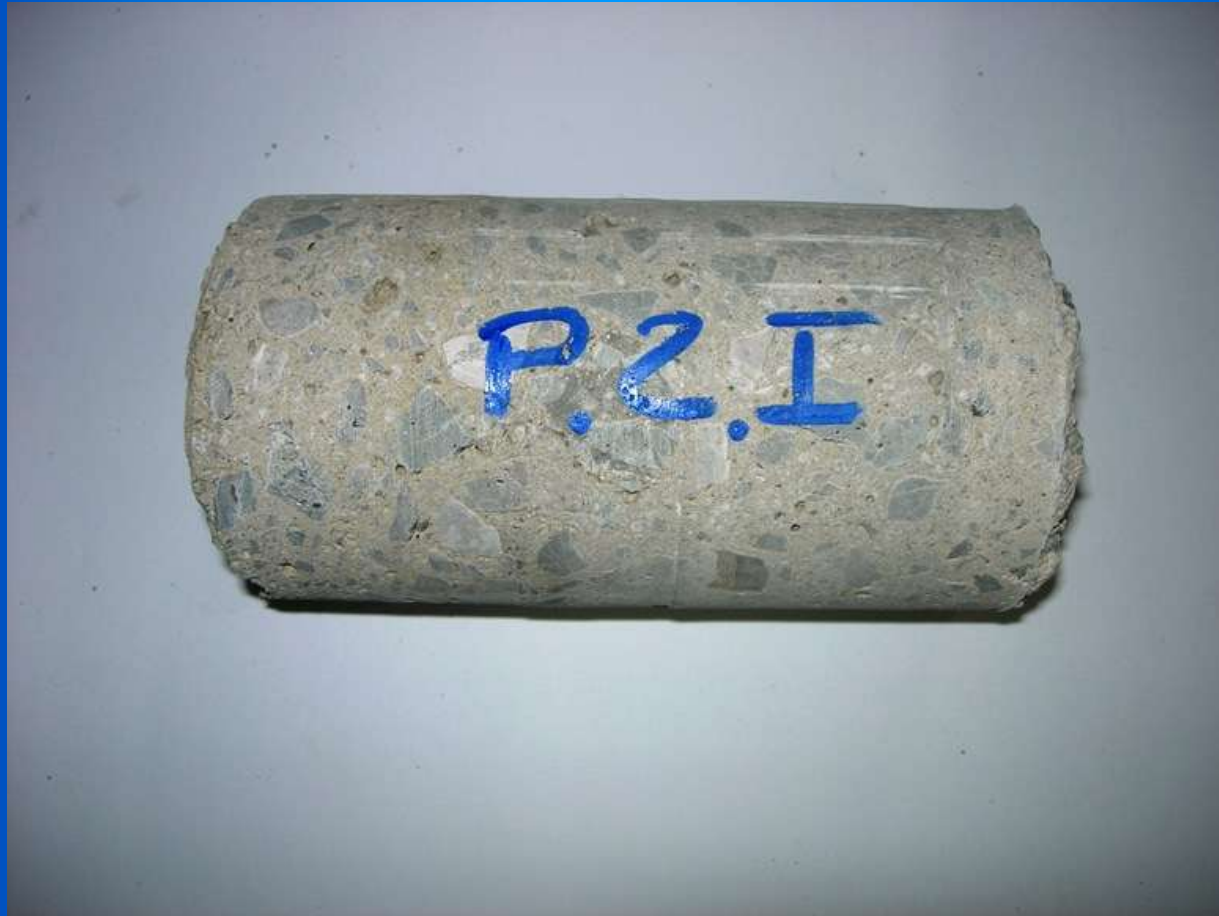
Carota di calcestruzzo
