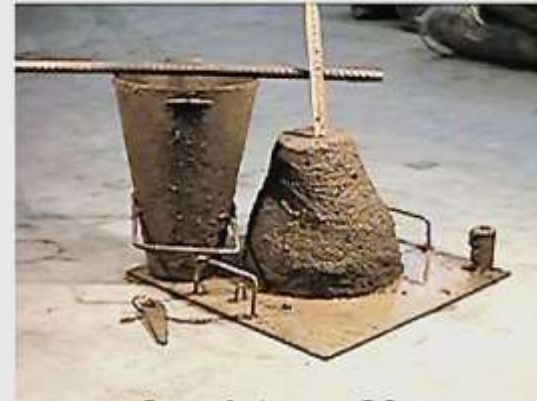
Consistenza S2 slump 50 - 90 mm
