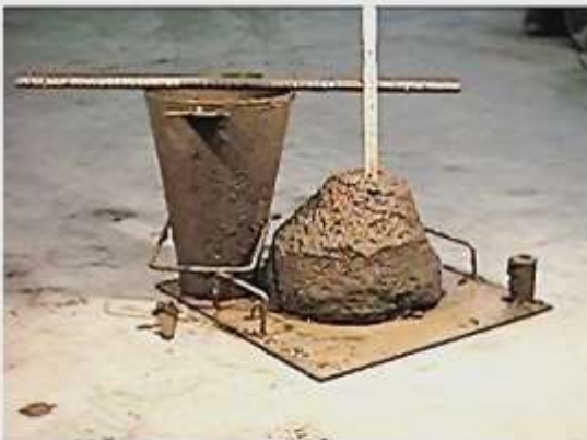
Consistenza S3 slump 100 - 150 mm
