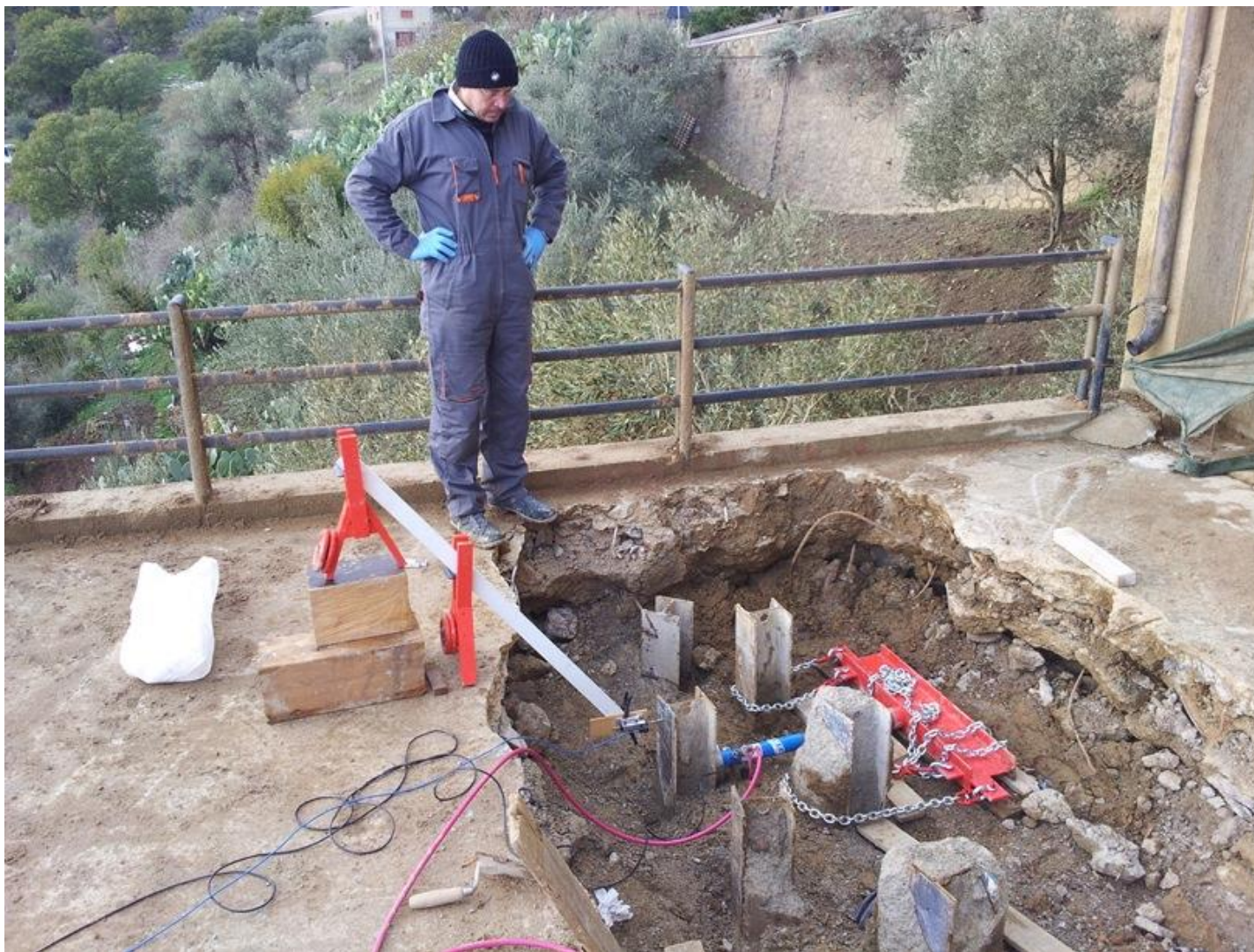
Prova a spinta su micropalo di berlinese
