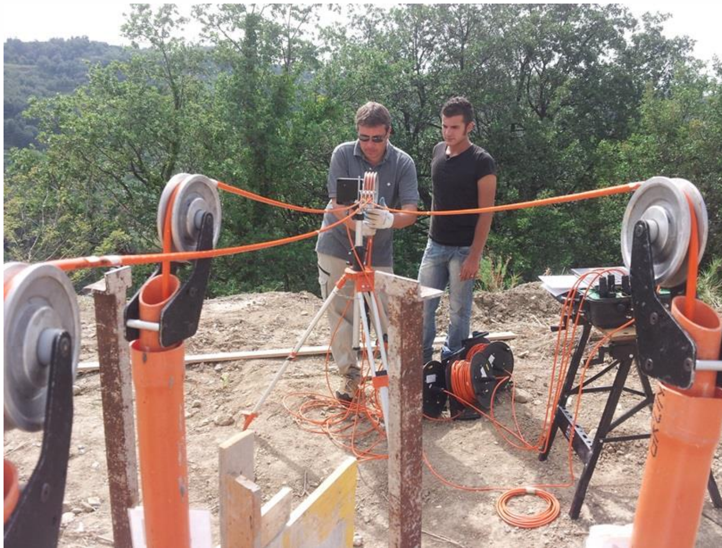
Esecuzione di prova Cross-Hole
