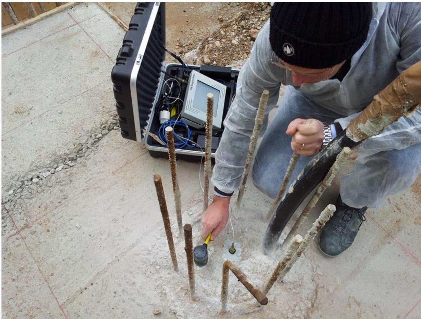
Esecuzione di indagine Pile Integrity Test
