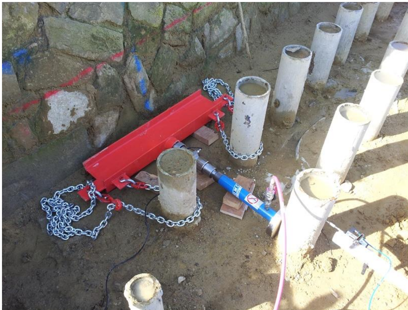
Prova a spinta su micropalo di berlinese
