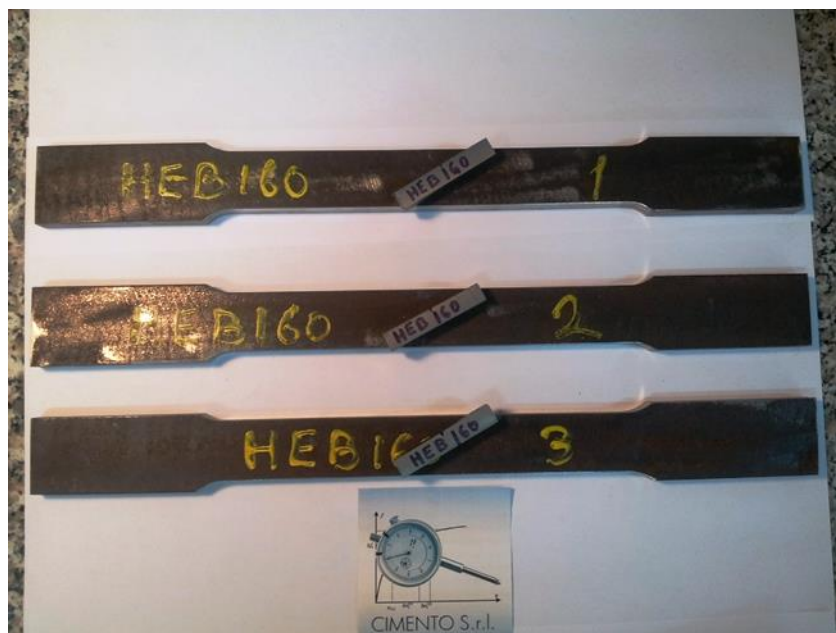
Provette di acciaio per prova a trazione e prova di resilienza
