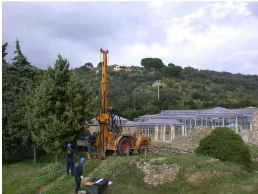
Esecuzione di indagine geotecnica e cassetta catalogatrice
