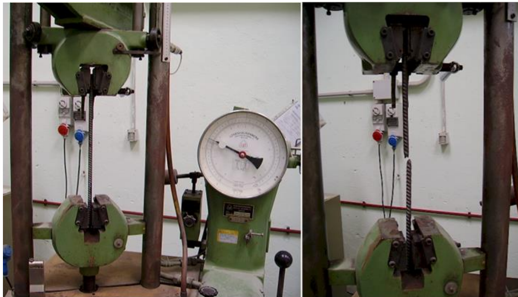
Prova di trazione
