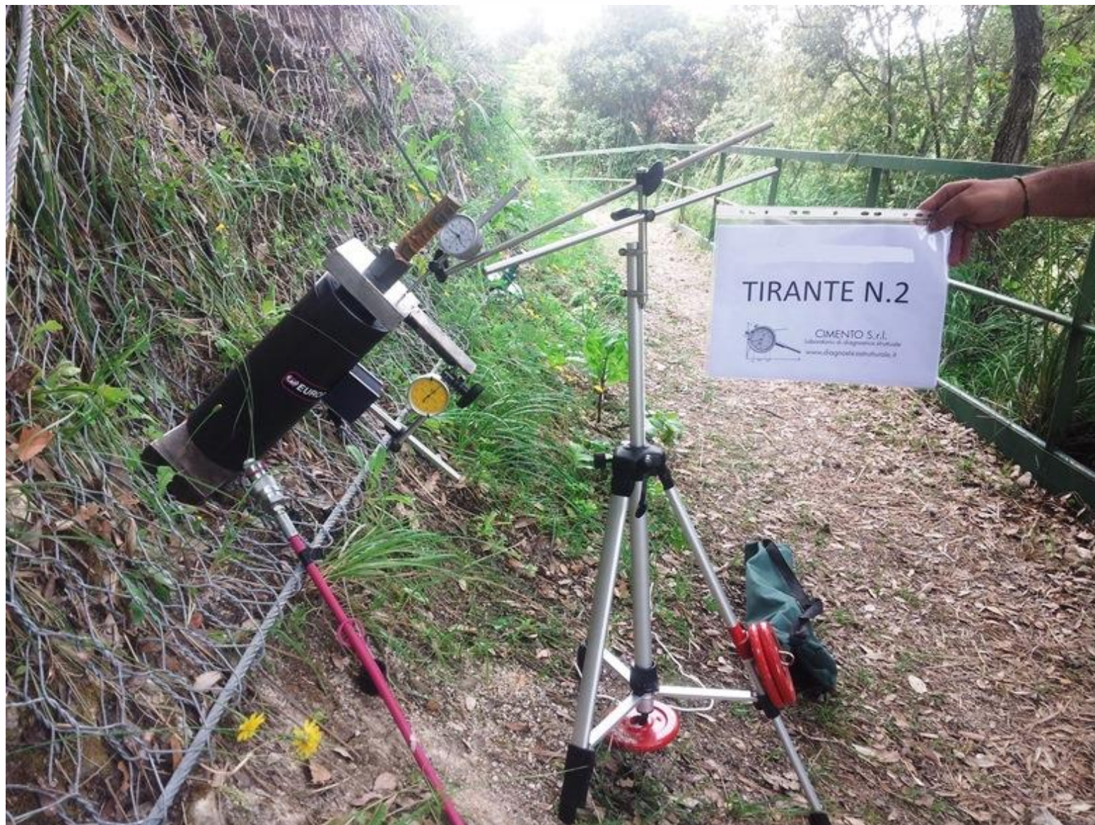
Prova su tirante a barra DYWIDAG
