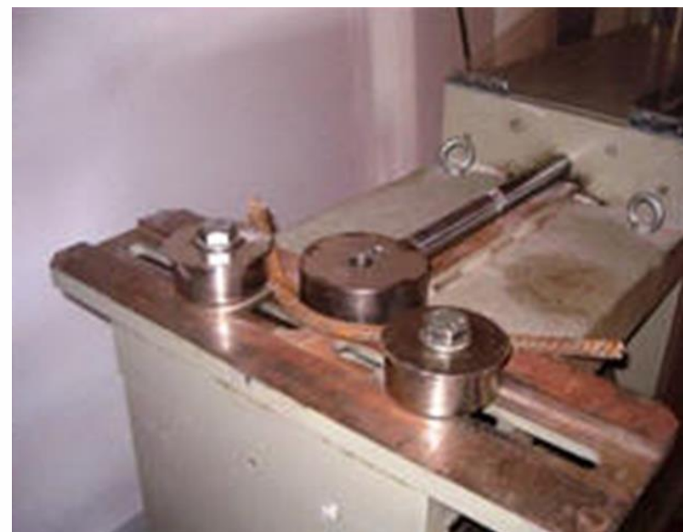
Prova di piegamento
