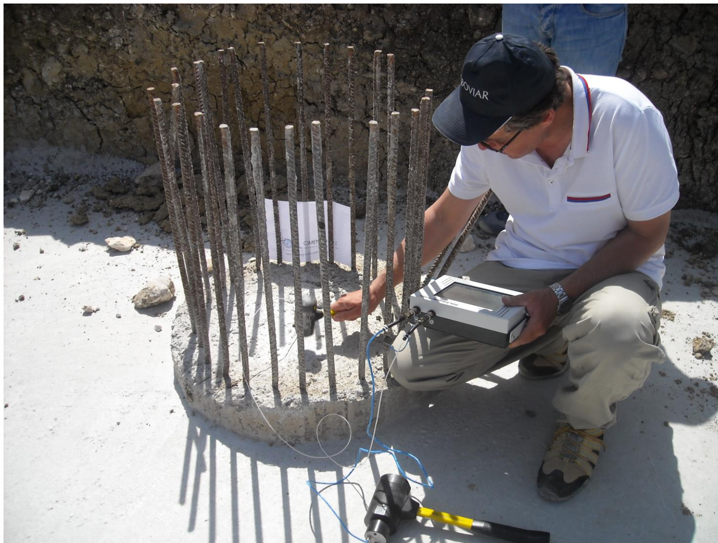
Esecuzione di indagine Pile Integrity Test
