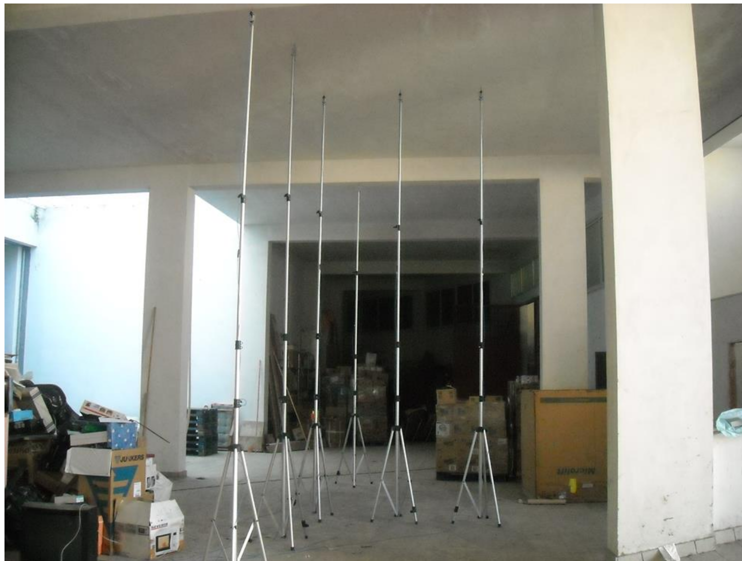
Esempio di prova di carico: disposizione trasduttori di spostamento
