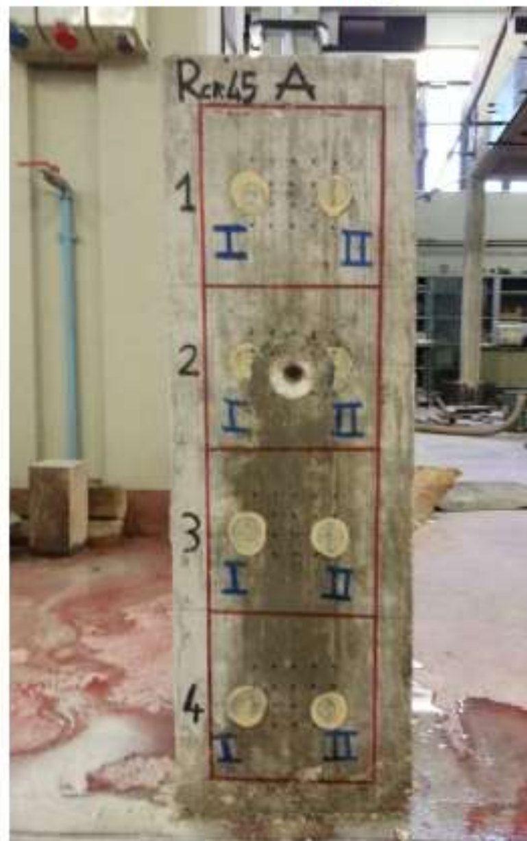
Foro rimanente sul pilastro
