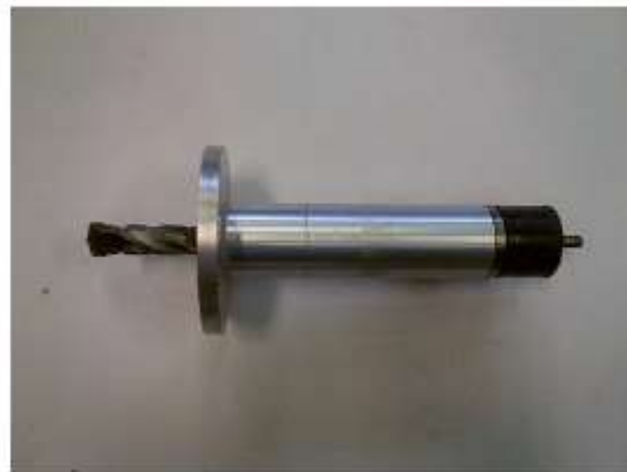
Guida a baionetta per trapano percussore per realizzare perforazioni perpendicolari alla superficie di prova
