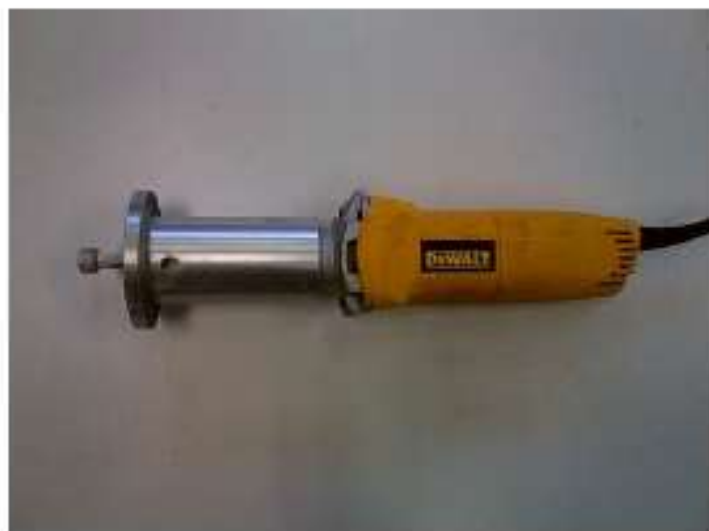
Fresa diritta per esecuzione alesaggio con disco diamantato della sede della testa del tassello
