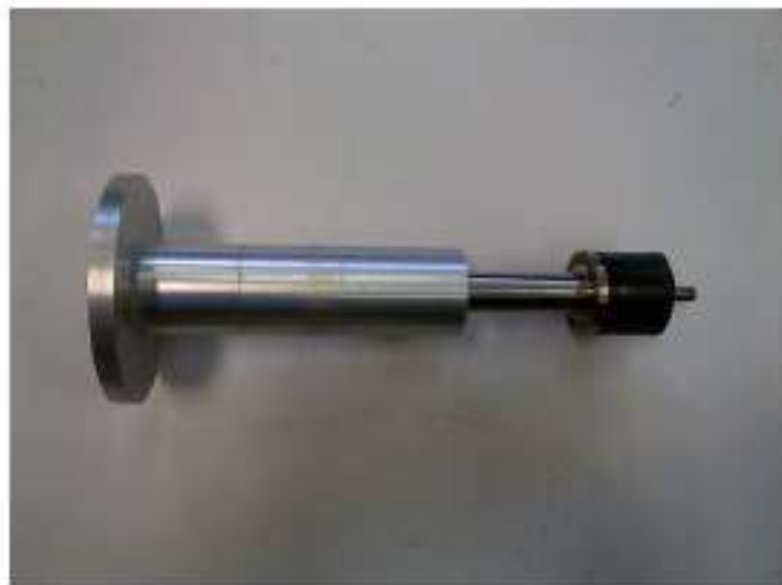
Guida a baionetta per trapano percussore per realizzare perforazioni perpendicolari alla superficie di prova
